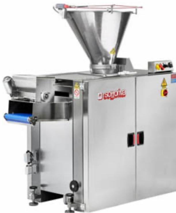
Загруженное в бункер тесто порционируется за счет движения поршня, после чего заготовки могут быть собраны вручную или запущены на автоматическую линию.
