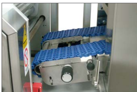
Speciale divaricatore ad una e due file a tappeto plastico antiaderente di grande spessore e resistenza.
