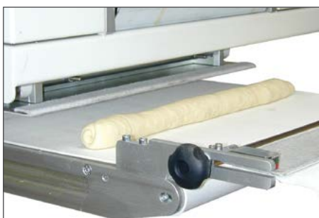
Particolare del filonatore per la produzione di filoni e baguette posizionato nei tappeti di riposo tra la prima e la seconda formatrice.
