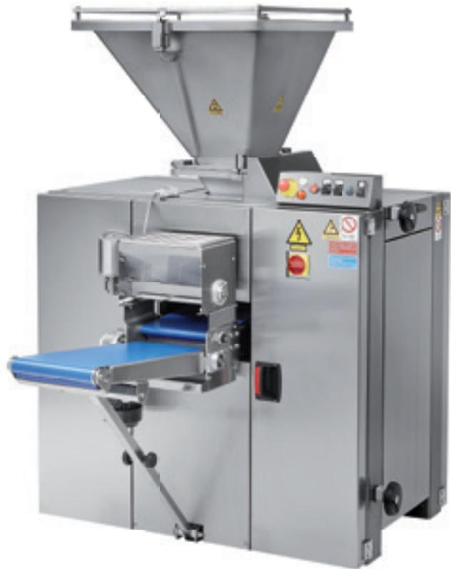
Carter in acciaio inox. Tramoggia in acciaio inox AISI 304 per kg 100 ca. di pasta. Spezzatura regolabile mediante la rotazione di un volantino. Velocità di produzione regolabile con variatore da 700 a 1500 pezzi/ora per fila. Lubrificazione con pompa automatica a 6 mandate. Sistema di pulizia molto semplice e rapido. La rimozione dei pistoni, dei coltelli, è molto semplice da effettuare, la pulizia può essere eseguita da chiunque con estrema facilità.
