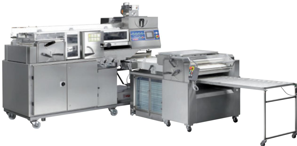
Gruppo automatico con intagliamento automatico per teglie da 60x80 o 60x100 cm. piane o ondulate. Possibilità di lavoro ad 1-2-3-4 file con pezzature variabili da 30-750 gr. e oltre. Regolazione elettronica della pezzatura con visualizzazione a display, rifasamento delle teglie in automatico. A richiesta inserimento della 5ª fila. Possibilità di abbinamento a celle di prefermentazione, a impianti automatici e ad alimentatori automatici. Scarico ciabatta e filonatore.
