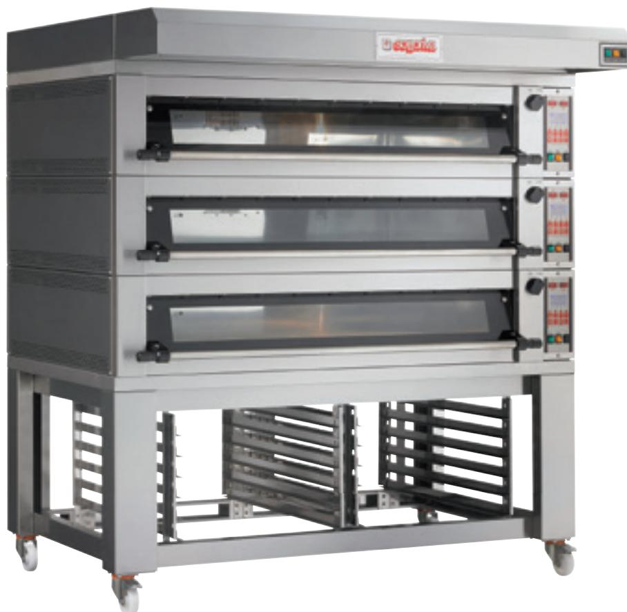
Forno con camere di cottura indipendenti. Piani cottura in cemento refrattario. Altezza utile delle camere di 18 o 24 cm. Ogni camera è dotata di uno strumento computerizzato per il controllo di tutte le funzioni del forno. Con vaporiera nella versione per pane.
