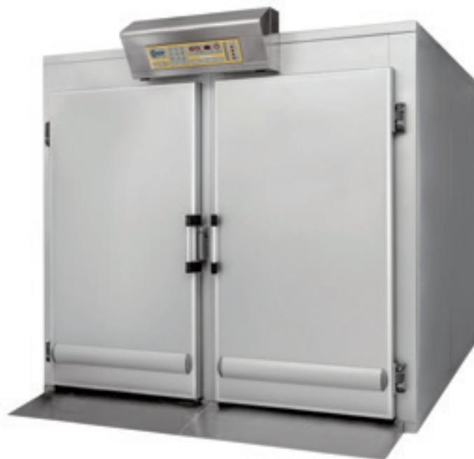
Cella di lievitazione ad alimentazione elettrica, con funzionamento indipendente dal forno. Costituita da pannelli in poliuretano espanso ad alto isolamento. Completa di sistema di riscaldamento e dotata di resistenze corazzate, termoregolatore automatico, ricircolatore d'aria a flusso regolabile, elettrovalvola per il controllo del livello dell'acqua, igrostatato di precisione per controllo dell'umidità, vaporizzatore a comando tramite l'igrostatato, luce interna di serie.
