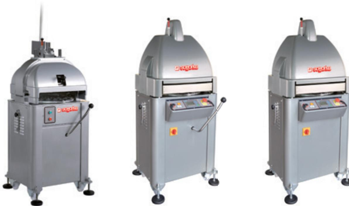
Spezzatrice arrotondatrice con struttura in lamiera di acciaio e dotata di 3 piatti. Viene prodotta in 3 versioni.
