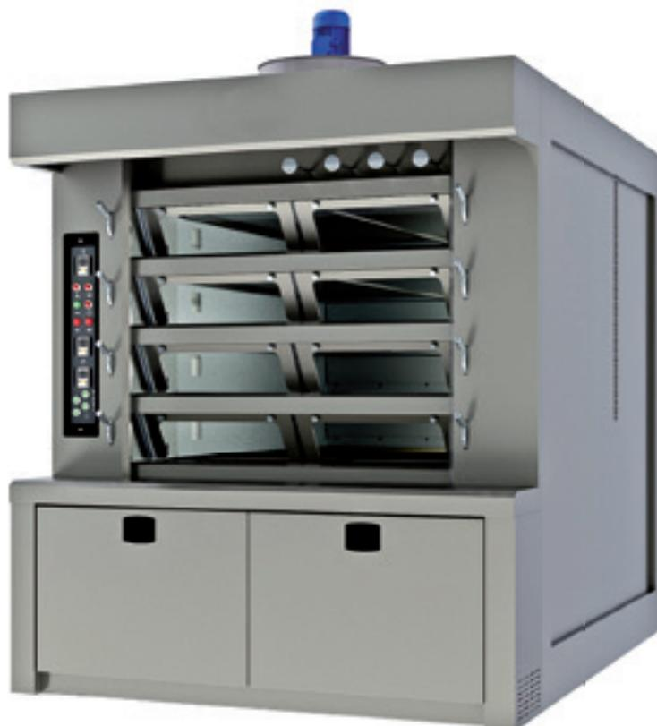
Forno statico a piani fissi completo di completo di piani di cottura refrattari in fibra di vetro, umidificatore dimensionato per un'abbondante erogazione di vapore, cappa aspirante motorizzata, valvola manuale per lo scarico del vapore in eccesso, portine in vetro temprato e facciata in acciaio inox.
