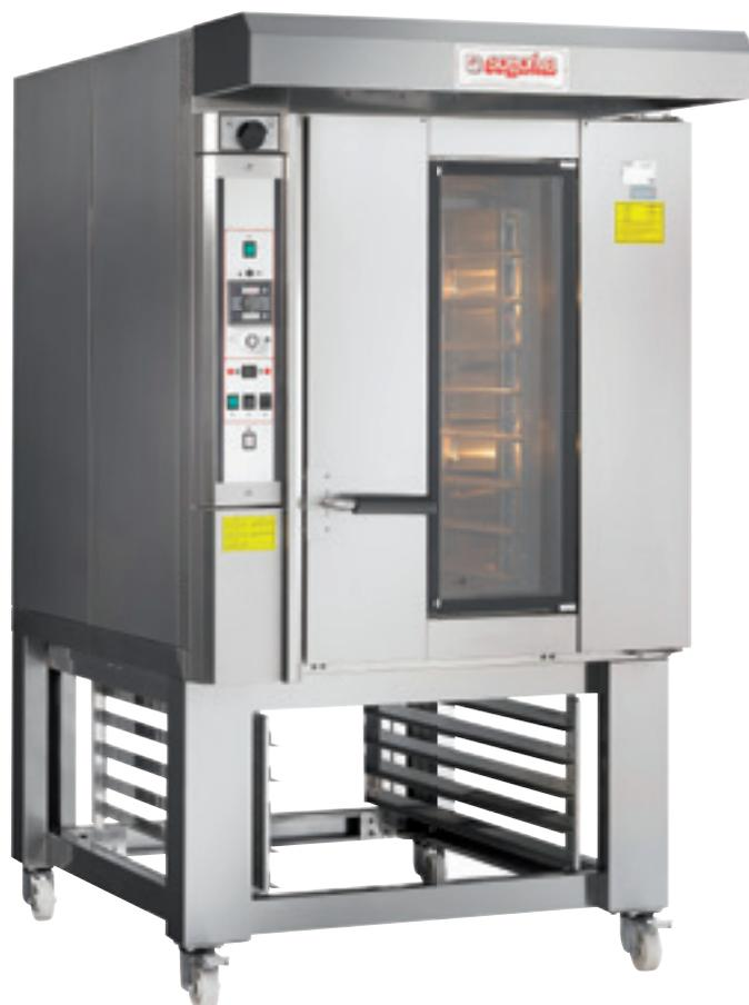
Forno per teglie 40x60, 46x66, 46x76, 40x80, 50x70 cm. Versione standard: sistema di rotazione con gancio superiore; 2 velocità di ventilazione; struttura del forno totalmente in acciaio inox; iniettore di vapore; valvole di scarico vapore; doppia luce interna; cappa con aspiratore; maniglia interna di sicurezza; copertura superiore. Con pannello elettromeccanico o digitale con schermo LCD e 30 programmi, accensione settimanale. Alimentazione a gas o gasolio o elettrico.
