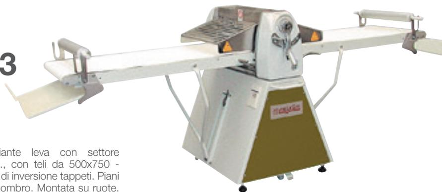
Regolazione graduale dei cilindri mediante leva con settore graduato. Larghezza tappeti 500/600 mm., con teli da 500x750 - 1000,600x1000-1400-1600 mm. Comando di inversione tappeti. Piani di lavoro rialzabili, per ridurre al minimo l'ingombro. Montata su ruote. Ripiani antinfortunistici a griglia. A richiesta teli di diverse misure.
