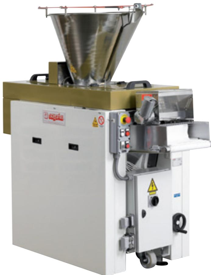
La spezzatura è regolabile volumetricamente mediante la rotazione di un volantino; il variatore di velocità è regolabile con rotazione manuale di un volantino; la tramoggia in acciaio inox ha una capacità di 80 kg. ca.; lo sfarinatore automatico incorporato è regolabile fino a chiusura completa; il tappeto d'uscita è azionato da un motorino indipendente. La macchina viene fornita con tappeto corto, e a richiesta con tappeto lungo.
