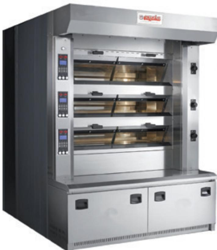
Forno a camere indipendenti, completamente smontabile e ad alto rendimento termico. Il sistema di controllo elettronico assicura la massima economia di gestione senza perdita di potenza in camera garantendo così risparmio energetico e qualità del prodotto. Tutti gli organi sono accessibili dalla facciata consentendo così, la massima facilità di manutenzione. Struttura in acciaio, facciata e parti soggette ad usura in acciaio inox satinato.
